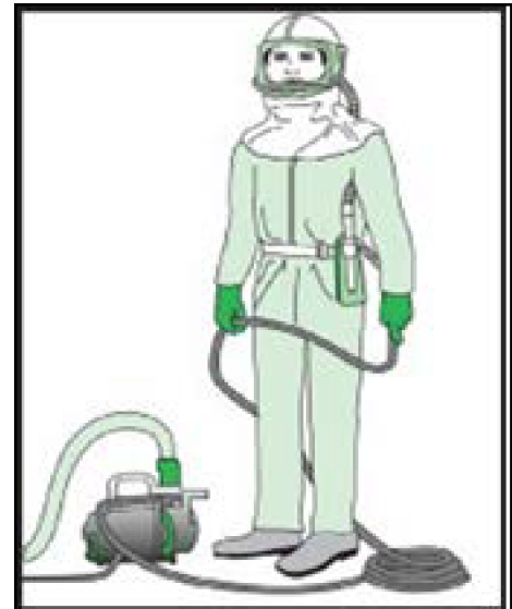
Figura 4-2. Respirador con suministro de aire (SAR). Este tipo de respirador con suministro de atmósfera pesa menos que los SCBA y proporciona un uso más prolongado. (Ilustración © National Pesticide Applicator Certification Core Manual, NASDA)
